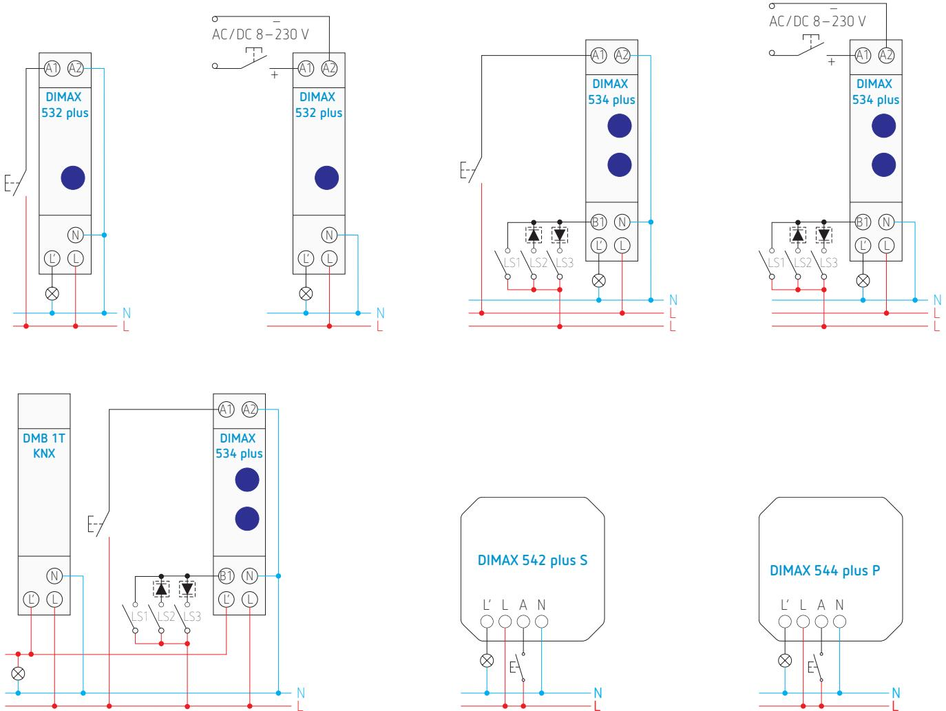
Avec booster DMB 1T KNX pour étendre la puissance de variation jusqu'à 700 W
