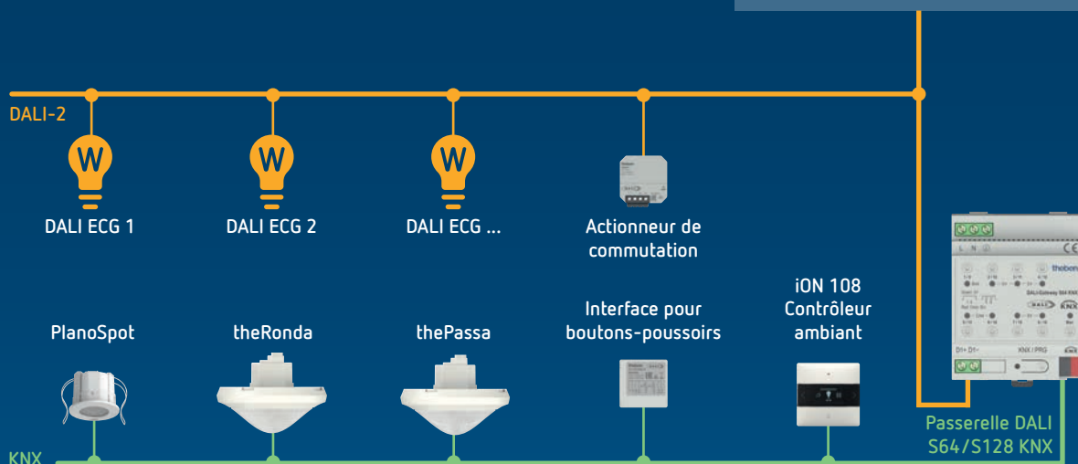
Schéma du système : contrôleur d'application maître unique
