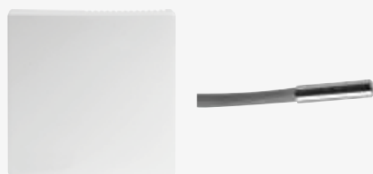
STAD01-NTC10K , sonde de température, NTC 10 kΩ, IP30, 85 × 85 × 31 mm STLD01-NTC10K , sonde de température NTC 10 kΩ, IP65, -25 – +125 °C
