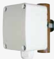
907.0.489, capteur de température en applique dans un boîtier à couvercle rabattable pour mesurer la température sur des tuyaux et des surfaces bombées
