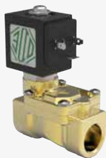
21W4KV250-BDA230, électrovanne 2 voies 1", NF, 230 V AC, 8 W, FKM
