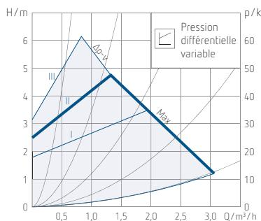
Réglage préférable pour une installation avec radiateurs ou plancher chauffant. La vitesse du circulateur s'adapte en fonction des variations de charge du circuit.
