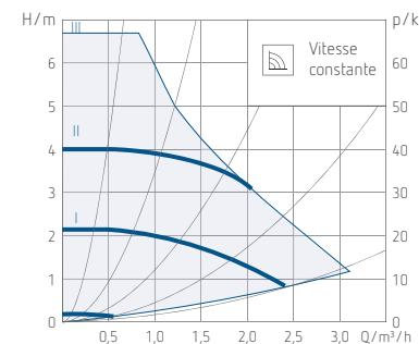
Réglage préférable pour un circuit dont les pertes de charge ne varient pas. La vitesse du circulateur est constante.
