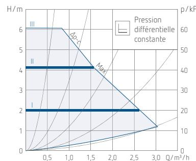
Réglage préférable pour une installation en plancher chauffant. La vitesse du circulateur s'adapte pour maintenir la pression constante.
