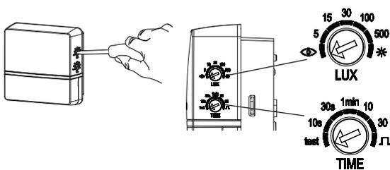
Seul le détecteur de mouvement TECTA D180 (1010100/1010101) possède 2 potentiomètres pour régler la luminosité (LUX) et la temporisation à l'extinction (TIME).
