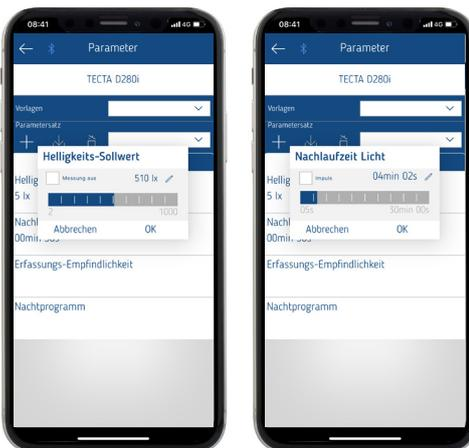
Il est possible de régler ici la valeur de luminosité de 2 à 1000 lx, la mesure désactivée et la temporisation à l'extinction (par défaut 5 lx, 30 s).
