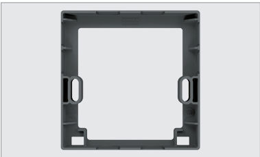
SPACER AN 9080032, afstandsraam voor de doorgang van zij- of bovenkabels, montage tussen de sokkel en de detector
