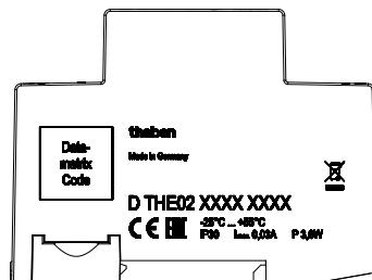
① Les caractéristiques de puissance se trouvent sur les côtés et sur le socle de l'appareil (voir image) et ne sont plus visibles après l'installation !
