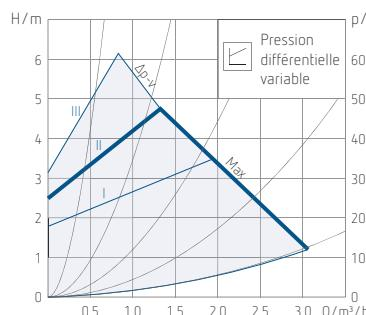
Réglage préférentiel pour une installation avec radiateurs ou plancher chauffant. La vitesse du circulateur s'adapte pour faire varier la pression.
