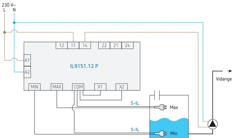
Pour la mise en marche de pompes jusqu'à 600 W, 230 V AC, vous pouvez utiliser directement le contact du relais de niveau.
