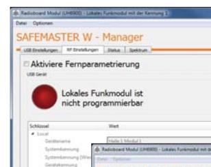
► **Affichage** (identifiants des dispositifs, bande de fréquence réglée à 433 MHz ou 869 MHz, puissance de transmission perçue)
