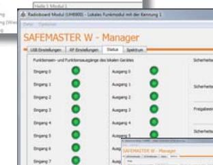
► **Réglage** (noms des appareils des deux modules reliés par radio UH 6900, canal de fréquence, puissance de transmission)
