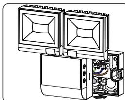
➤ Raccorder le projecteur à LED au réseau
