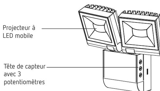
Le projecteur à LED possède 3 potentiomètres pour régler la durée (Min), la luminosité (Lux) et le mode de fonctionnement.
