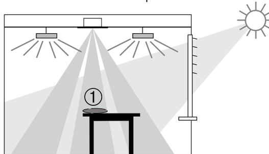
Facteur de correction de pièce = luminosité au plafond / luminosité au niveau de la surface de travail
