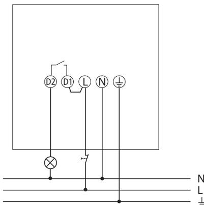
L'appareil peut être activé manuellement à l'aide d'un bouton-poussoir d'interruption. Une fois que le bouton-poussoir a été relâché (retour de la tension), l'appareil s'enclenche (pour au moins 40 s ou pour la durée définie pour l'appareil).
