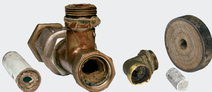
Échantillons de tuyauteries entartrées par l'eau calcaire
