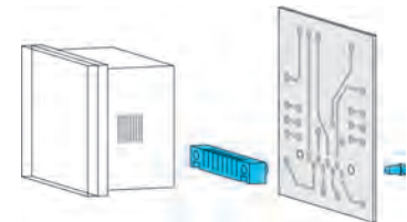
Montage sur circuit imprimé avec barrette de connexion, réf. 907 0 066 en option
