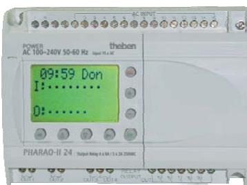
La fonction PS607 convient pour la commande de six circulateurs chauffage, un circulateur eau chaude sanitaire et un brûleur. La fonction PS607 convient également comme module multizone MZ 007 pour une installation avec 7 circuits chauffage d'égale importance (pas de priorité).
