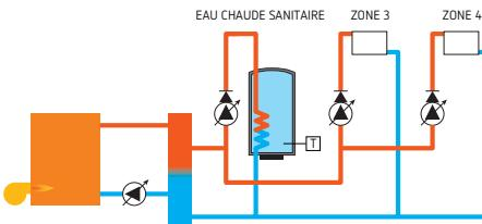
**Remarque :** les flow-valves sont indispensables pour éviter une circulation par thermosiphon de l'eau chaude dans les circuits dont le circulateur est à l'arrêt.
