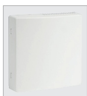
STAD01-NTC10K , temperatuursensor, NTC 10 kΩ, IP30, 0 – 50 °C, 85 × 85 × 31 mm
