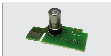
ACQ M01 , vooraf gekalibreerde vervangende methaansensor
