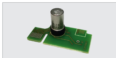
ACQ G01 , vooraf gekalibreerde vervangende LPG-sensor
