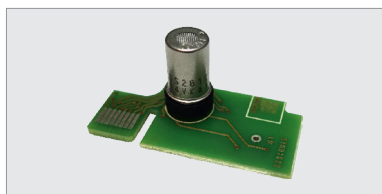
ACQ G01 , capteur LPG de remplacement précalibré
