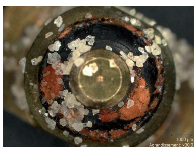
Joint non traité: présence d'impuretés déposées
