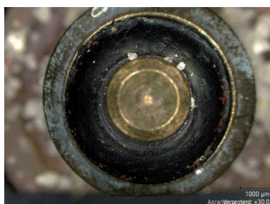
Behandelde afdichting: aanzienlijke vermindering van verontreinigingen
