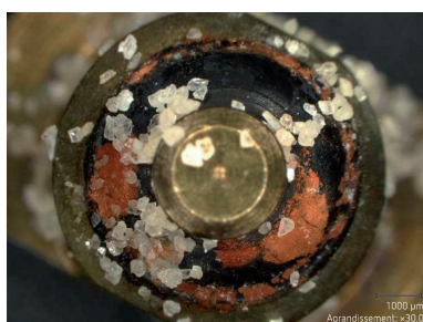
Onbehandelde afdichting: aanwezigheid van afgezette verontreinigingen
