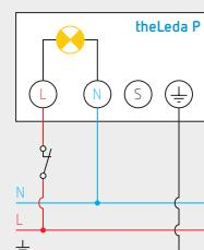
Possibilité de raccorder un bouton-poussoir NF pour allumer et éteindre manuellement l'éclairage
