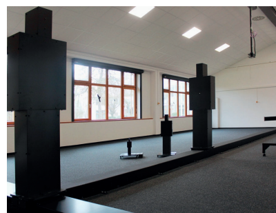
Mannequins van drie verschillende maten simuleren verschillende installatiehoogtes
