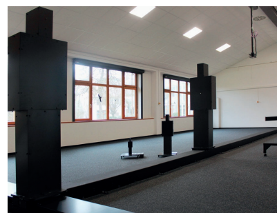
Des mannequins de trois tailles différentes simulent les différentes hauteurs de montage
