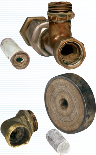
Échantillons de tuyauteries entartrées par l'eau calcaire
