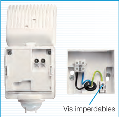
Raccordement facile grâce au socle enfichable ① fixation du socle au mur ② raccordement aisé (bornes spacieuses) ③ enfichage du détecteur
