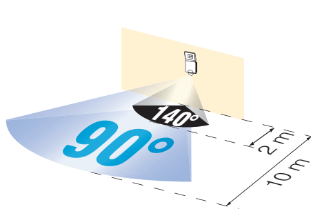
LUXA 102-140 LED 8W, LUXA 102-140 LED 16W Protection anti-angle mort: 140^\circ pour une portée de 2 m
