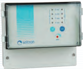
RGI 004 avec maximum 4 capteurs à distance
