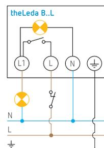
Avec theLeda B Motion Module : possibilité de raccorder un bouton-poussoir NF pour allumer manuellement l'éclairage. Retour au mode automatique en appuyant sur le bouton-poussoir
