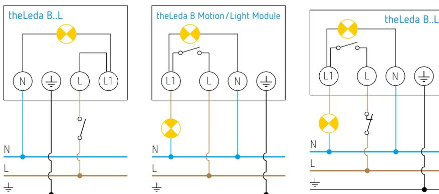
**theLeda B..L + theLeda B Motion Module** : possibilité de raccorder un bouton-poussoir NF pour allumer manuellement l'éclairage. Retour au mode automatique en appuyant sur le bouton-poussoir.
