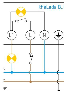
theLeda B..L + theLeda B Motion Module : possibilité de raccorder un bouton-poussoir NF pour allumer manuellement l'éclairage. Retour au mode automatique en appuyant sur le bouton-poussoir.
