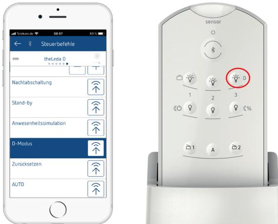
① Le détecteur de mouvement réagit uniquement à la luminosité. La lampe à LED est toujours allumée lorsque la luminosité est inférieure à la valeur de luminosité réglée.
