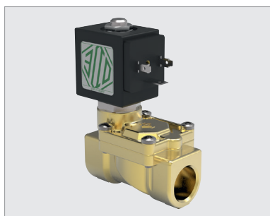
21WA4KOV130-BDA230AC-305 , électrovanne 2 voies 1/2", NF, 230 V AC, 8 W, FKM
