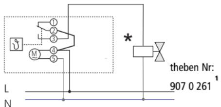
**D** Regelung über Öl-/ Gasfeuerungsrelais
