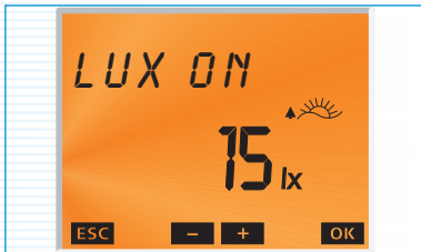
Affichage rétro-éclairé pour les seuils d'enclenchement et de déclenchement, les temporisations, la valeur lux mesurée, etc.
