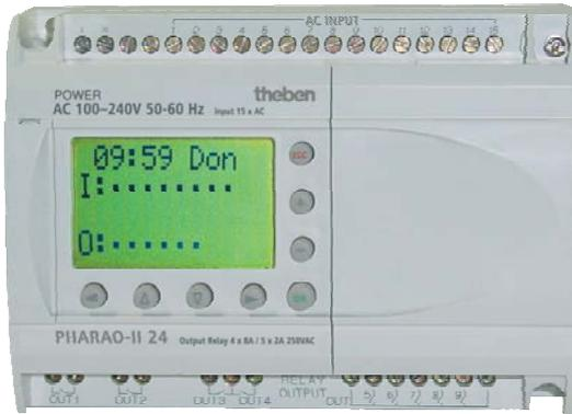
La fonction PS666 convient pour la commande de six zones de chauffe (circuit chauffage, circuit eau chaude sanitaire, circuit piscine, etc.), un brûleur 2 allures ou un brûleur une allure avec un circulateur de boucle primaire temporisé.
