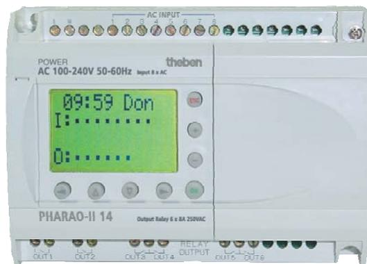
La fonction PS444 convient pour la commande de quatre zones de chauffage (circuit chauffage, circuit eau chaude sanitaire, circuit piscine, etc.), d'un brûleur et d'un circulateur de boucle primaire.
