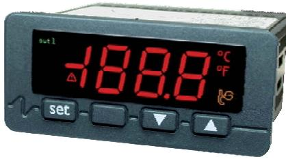
Le TS 430 est un thermostat digital à 3 ½ digits prévu pour des plages de températures comprises entre -200 et +1300 °C selon le type de sonde. Le thermostat peut être raccordé à un thermocouple J ou K, une Pt100, Pt1000 ou Ni120 deux ou trois fils, une sonde PTC 990 Ω à 25 °C, une NTC 10 kΩ à 25 °C ou encore être piloté par un signal 4 à 20 mA, 0 à 20 mA, 2 à 10 V ou 0 à 10 V.
