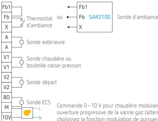
Fb1-Fb Ne rien raccordez s'il n'y a ni sonde d'ambiance ni thermostat d'ambiance. Ponez Fb1-Fb s'il y a un thermostat d'ambiance. Raccordez les bornes Fb1-Fb de la sonde d'ambiance si une sonde d'ambiance SAR2100 est utilisée.
